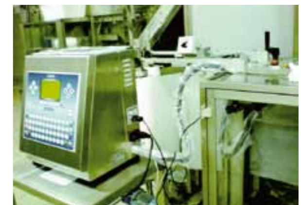
Le stampanti "Z4000 Smart" di Zanasi sono in grado di operare su qualunque film plastico
